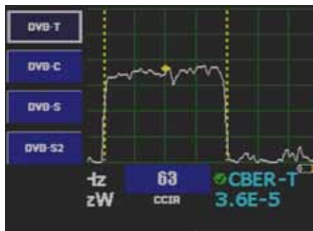
Измерение отношения C/N несущая-шум для цифрового канала
