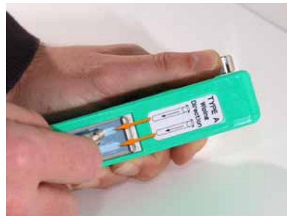
Очистка с помощью ленты
