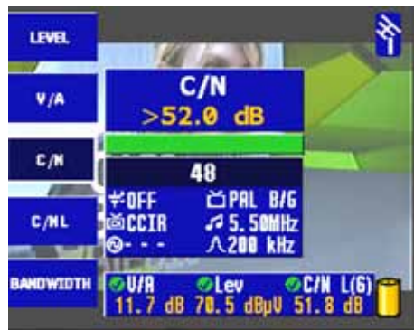
Измерение отношения C/N несущая-шум. Настройка канала
